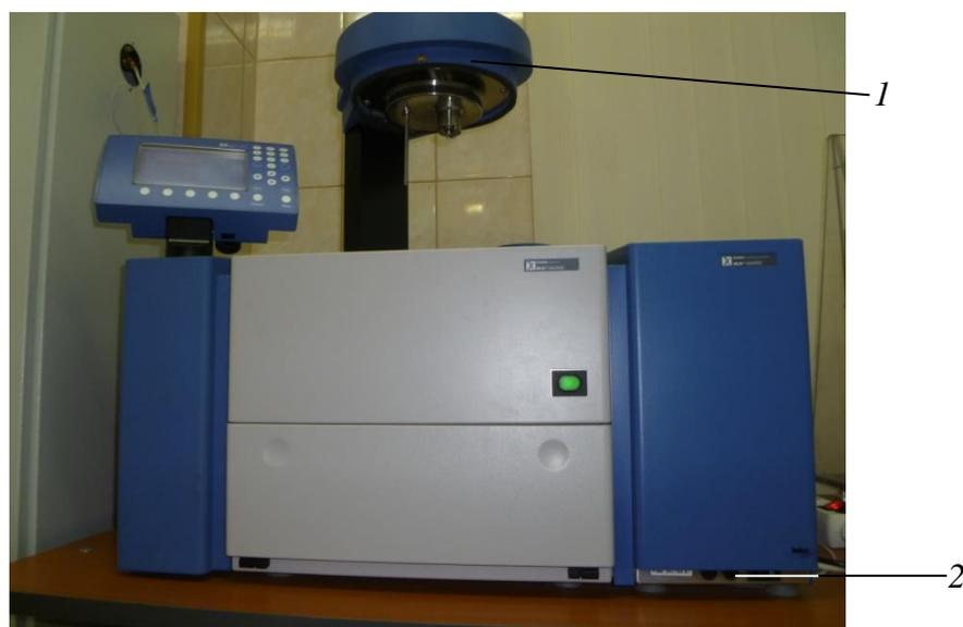
**Рис. 2.4 Калориметр с поднятой створкой измерительной камеры
